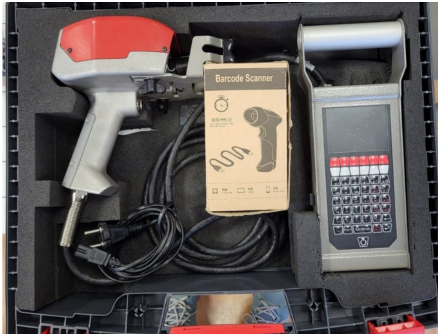
Bild 1: Die Codierhardware im Kasten. Von links nach rechts: Nadeldrucker, Barcode-Scanner (in Verpackung) und Codiergerät. Im Codiergerät steckt seitlich links der Bluetooth Empfänger für die Verbindung mit dem Scanner.
