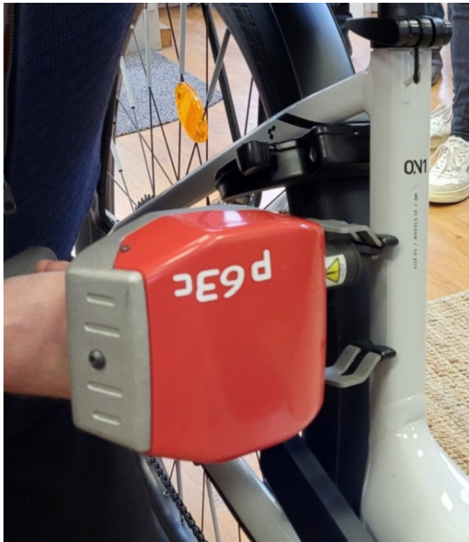
Bild 7: Den Nadeldrucker präzise über dem neutralen Aufkleber positionieren, ruhig halten und auslösen.
